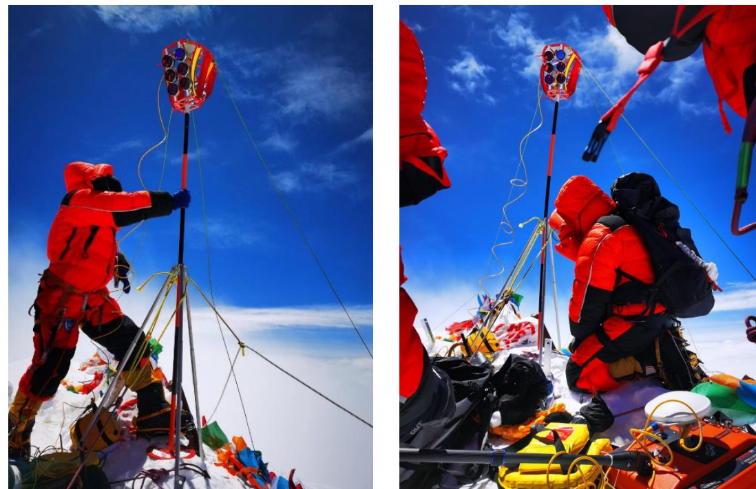
2020年珠峰高程测量全面使用国产装备，由南方测绘研制的雪深雷达和觇标登顶珠峰并完成测量任务
