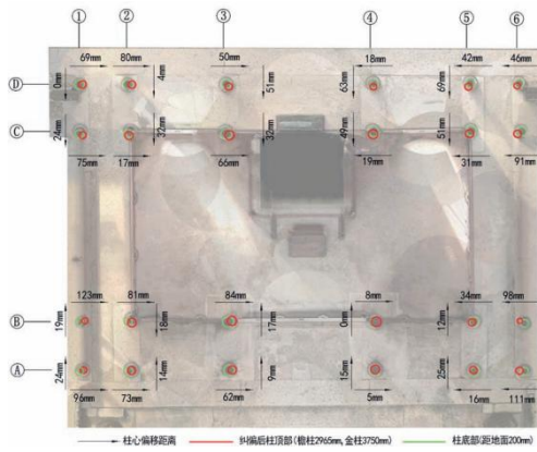
图 26 横向纠偏三维激光扫描
