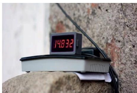
图 22 屋脊位移测量
