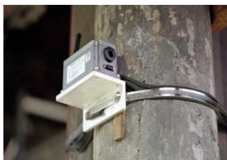
图 21 倾角仪木柱倾斜测量
